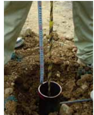
落下高さ確認
