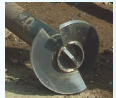
▲反転し、抜いた杭。 拡翼変形はしていない。
